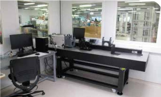
مقياس التداخل بالليزر Zygo
